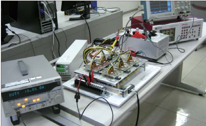
写真3 熱電素子によって作られた数十ボルトの直流電圧を家庭用の交流100ボルトに昇圧するための実験。変換に伴う損失を電力アナライザーで測定し、損失を低減する回路を研究している
