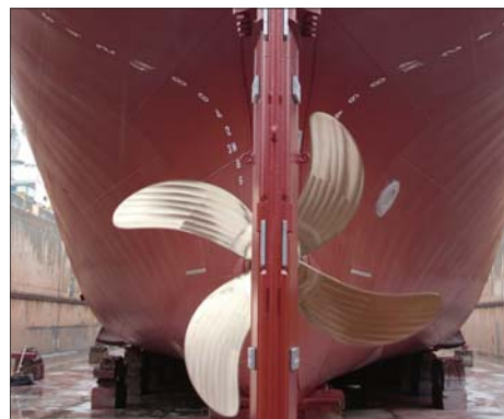
写真2 (左) 直径3メートルのケミカルタンカー用プロペラ ナカシマプロペラがつくるプロペラの表面には「ナカシマ模様」とも呼ばれる独特のしま模様が入っているため一目でわかる。 写真3 (右) 「第6回ものづくり賞」受賞 CFRP製プロペラの製造技術に対して内閣総理大臣賞を受賞した。
