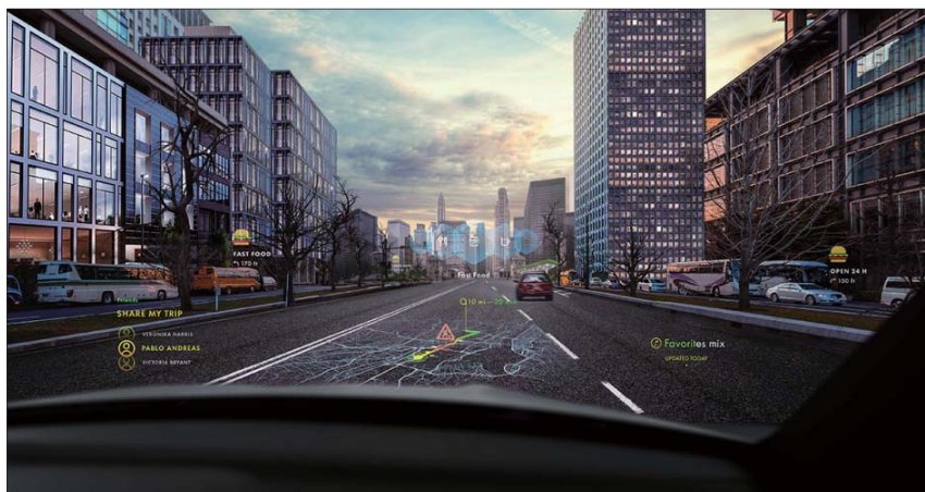
図1 フロントガラスに投影される道路上のバーチャルイメージ
